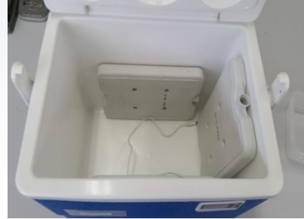
SENSOR PRÓXIMO AO GELOX
