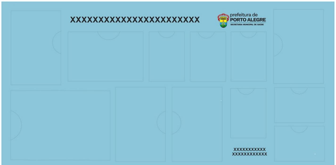
**5.34 - Inserção dos murais modelo 2** - Tamanho: 1mx1m em PS 3mm com adesivo em impressão digital e bolsos em acrílico sendo 7 para inserção de impressos no formato A4 e 2 para formato A3.
