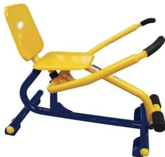
**8.11.1-BASE (simulador de remo):** em tubos de aço carbono de no mínimo 2" x 2,0mm, pintura a pó eletrostática com seis (06) banhos químicos sequenciais, coxim de borracha, com parafuso central 5/16 comprimento 55 mm; diâmetro de 30mm e porca rebite com aba plana rosca interna de 10mm; solda mig, orifícios para fixação do equipamento (parabout).
