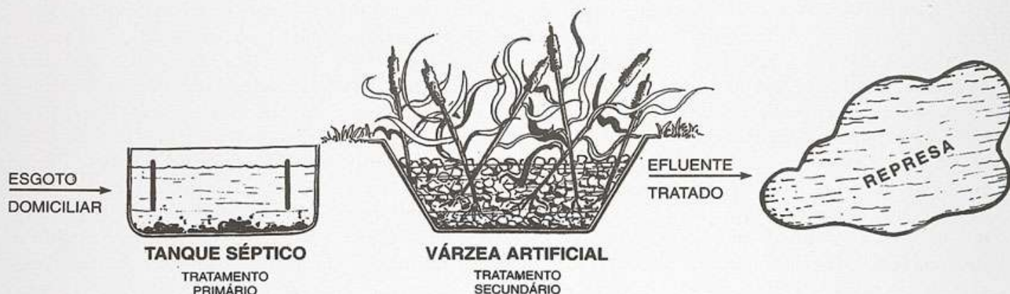
Figura 1 - Esquema do sistema tanque séptico-várzea artificial.
