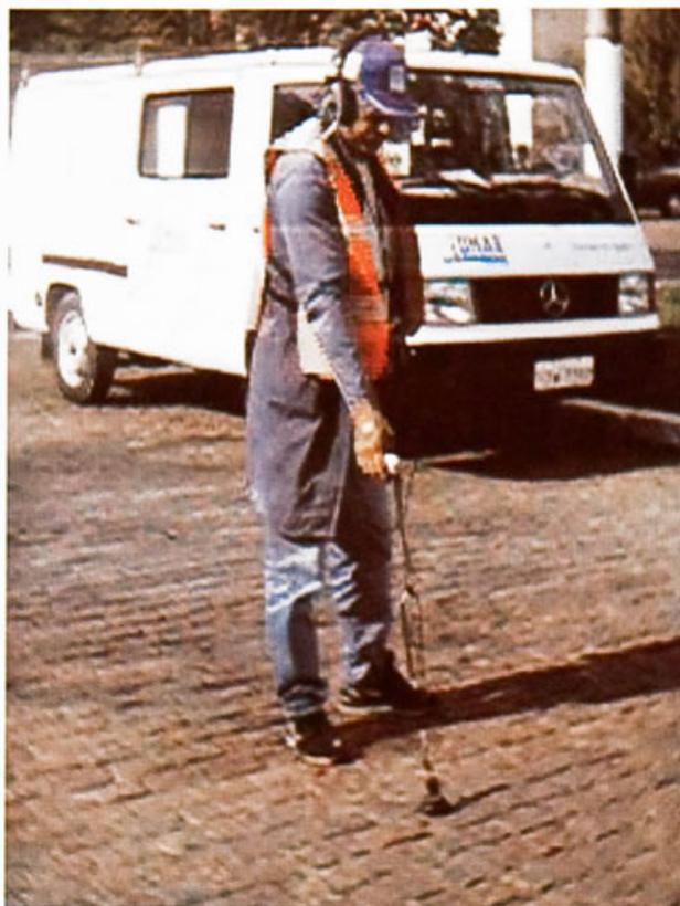
Geofone detecta os vazamentos não-aparentes na rede distribuidora.
