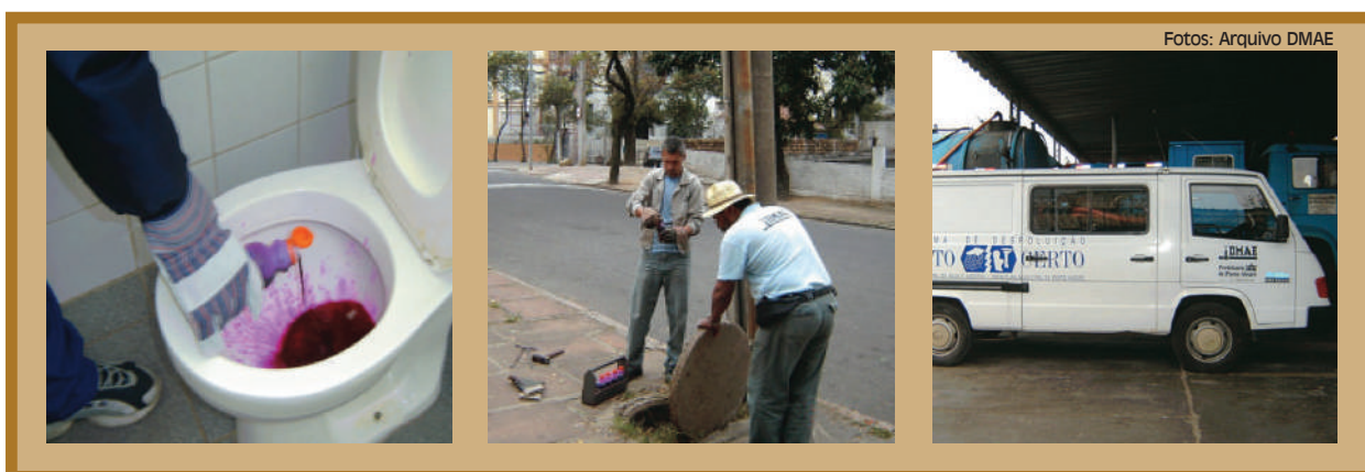
Figura 4. Fotos das atividades de teste de corante do STAV.
