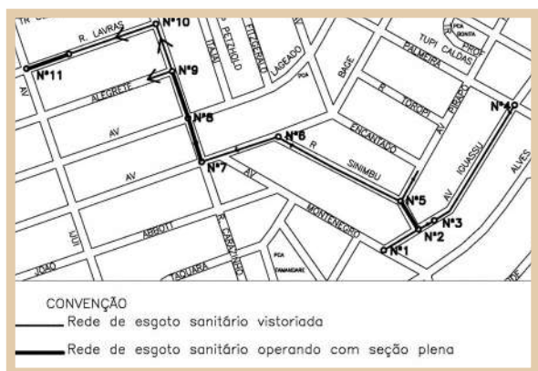
Figura 11. Resultado da vistoria das redes de esgoto sanitário da sub-bacia D11 em 07/06/2005.
