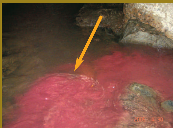
Figura 8. Fotos de infiltração de efluente cloacal misturado com corante pelo fundo do canal São Vicente, proveniente da rede de esgoto cloacal DN 150.
