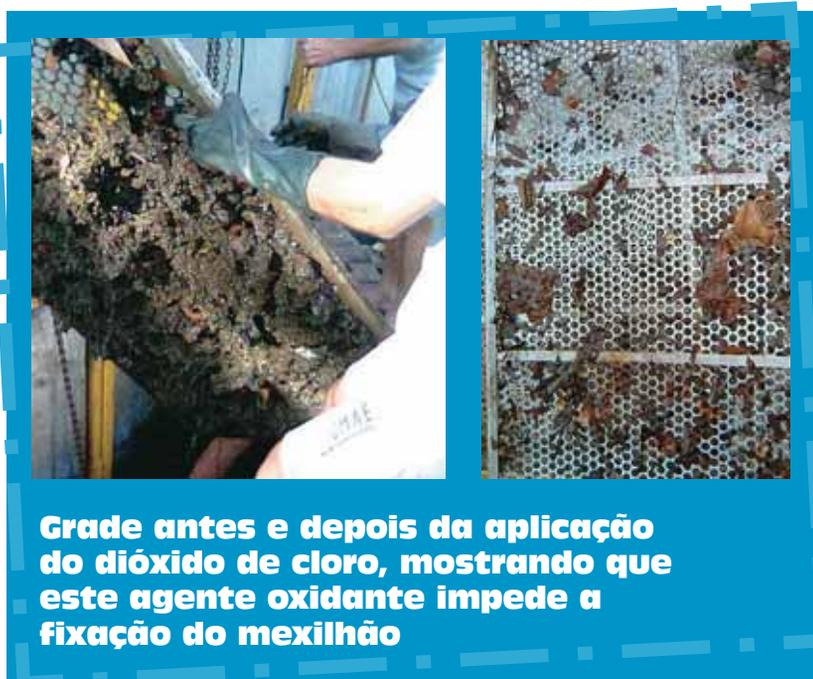
**Grade antes e depois da aplicação do dióxido de cloro, mostrando que este agente oxidante impede a fixação do mexilhão**
