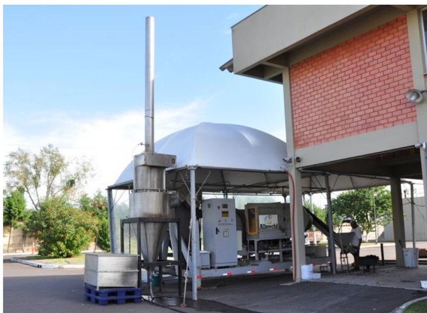
Figura 2 - Cobertura para o secador térmico.
