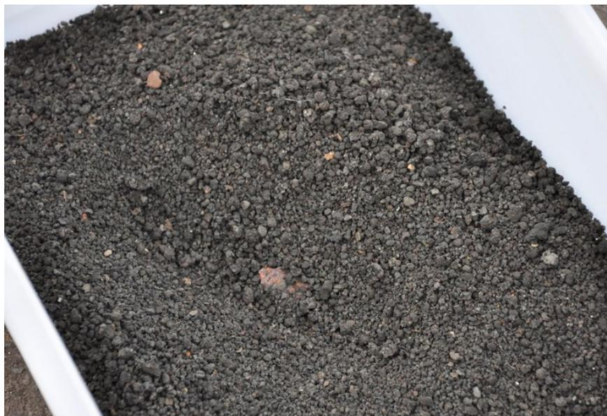
**Figura 3** - Lodo após secagem térmica.
