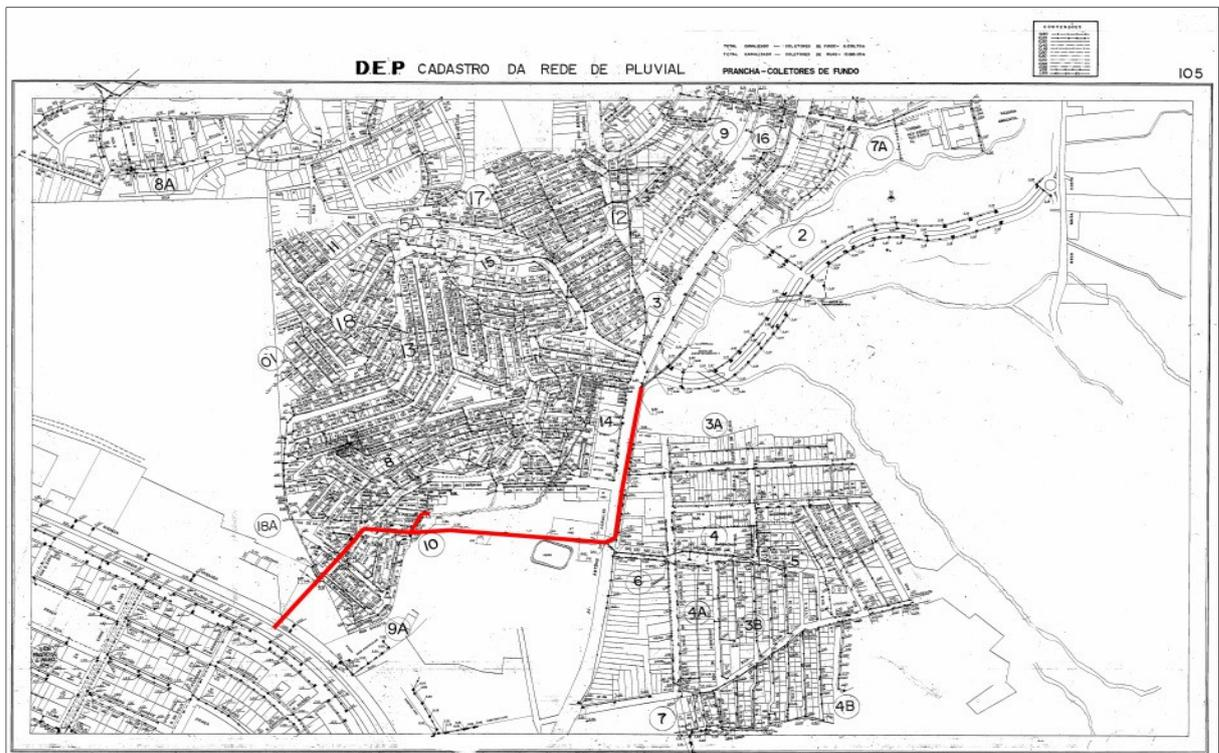
**Figura 8 – Rede Pluvial Existente – Vermelho Macrodrenagem e Preto Microdrenagem.**
