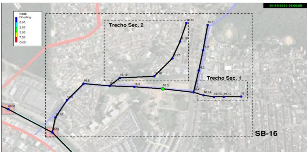
Figura 11 – Diagrama Unifilar para análise da rede de macrodrenagem existente.
