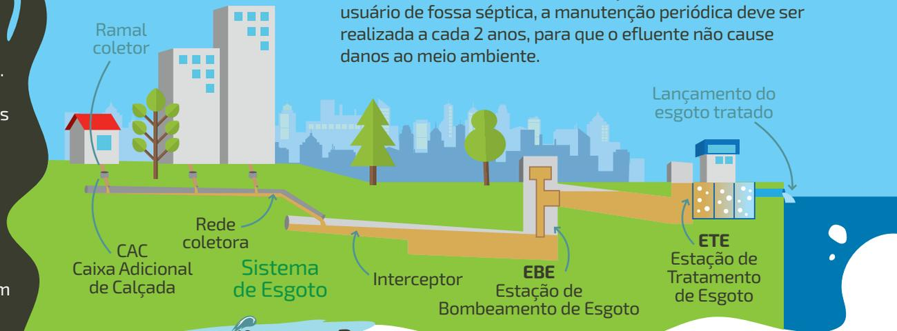
O esgoto cloacal é captado das residências - por intermédio de tubulações (canos), que constituem um sistema (rede) coletor de esgoto - para depois ser conduzido, por meio de bombas ou por gravidade, às Estações de Tratamento de Esgoto (ETEs).
