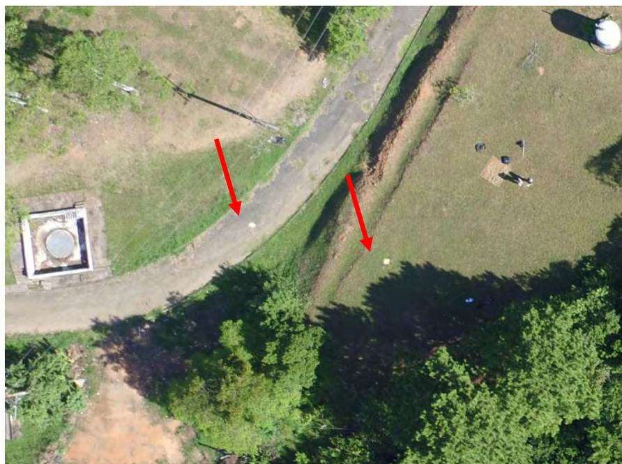
**Figura 13 - Representação de campo dos alvos posicionados que são utilizados para apoio ao georreferenciamento do mosaico aerofotogramétrico.**
