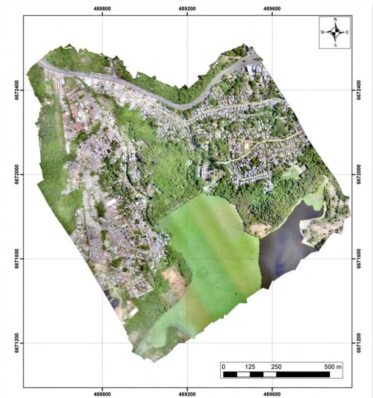
**Figura 14 - Versão em dimensão reduzida do mosaico aerofotogramétrico produzido para a área de interesse.**
