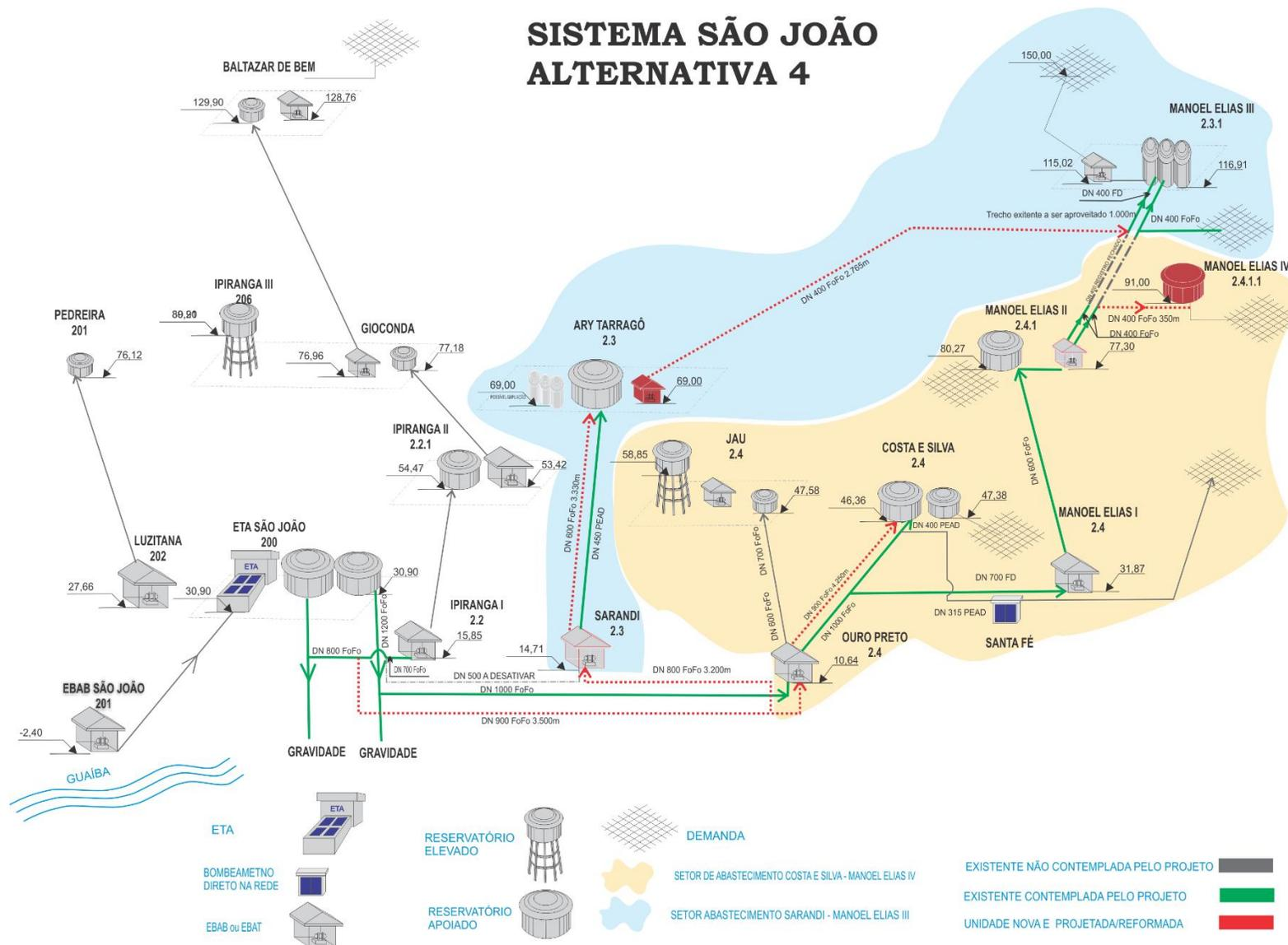
Figura 3.1 – Croqui da concepção de ampliação do Sistema São João.
