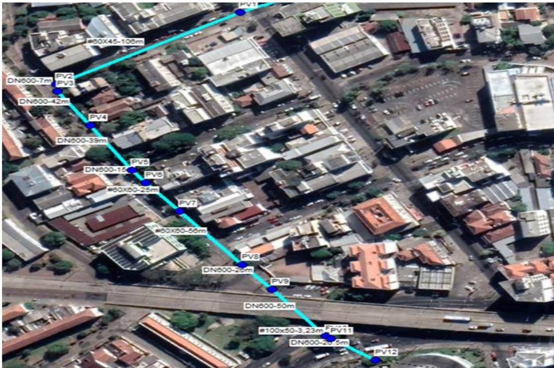
Figura 3 - Planta baixa contento seção hidráulica e extensão dos trechos.
