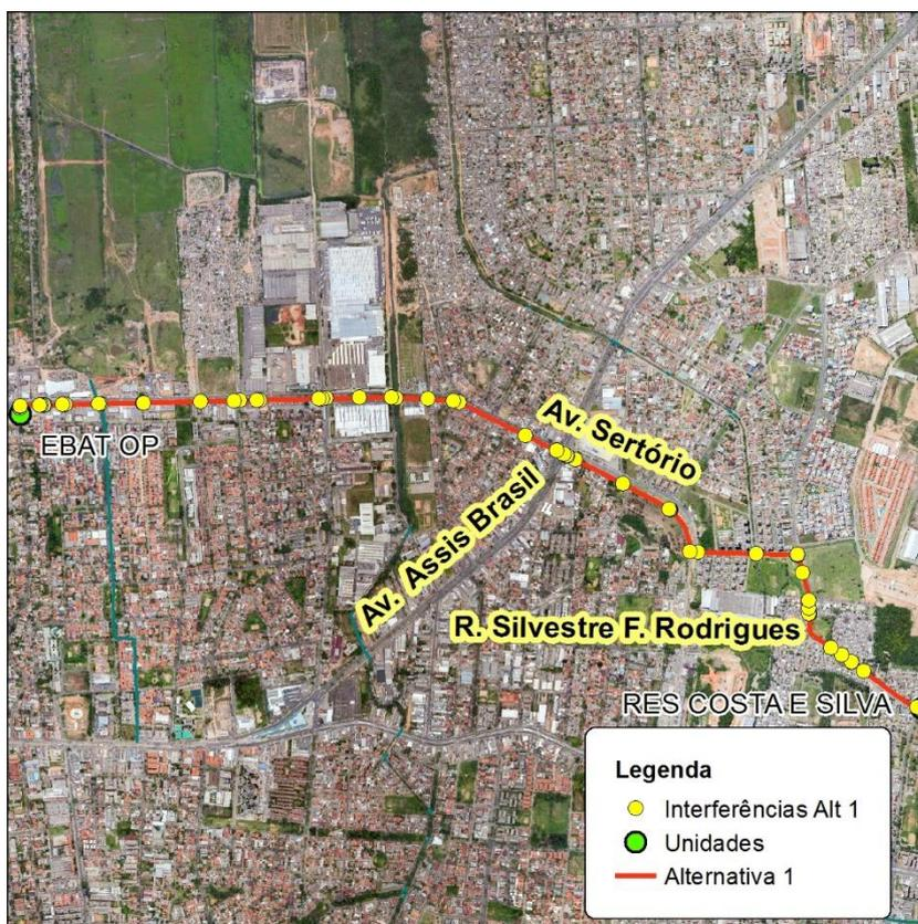
Figura 2.3 – Interferências existentes no traçado da Alternativa 1.
