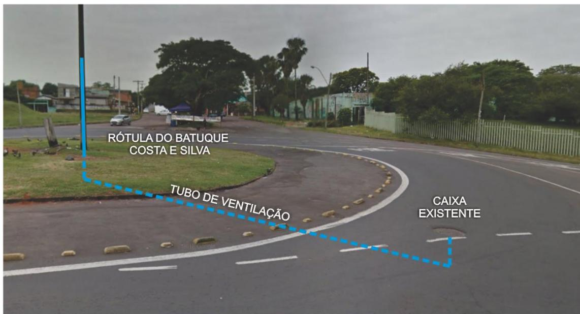
Figura 3.25 - Modelo esquemático do tubo de ventilação da ventosa V-11
