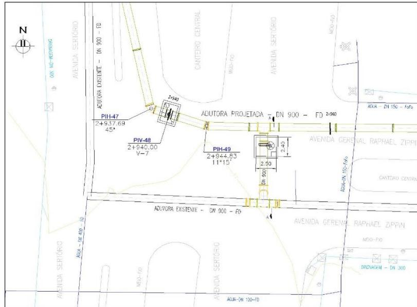
Figura 3.6 – Interligação na Av. Gal. Raphael Zippin, entre a Adutora Projetada e a Adutora Existente, com um registro de manobra entre elas.
