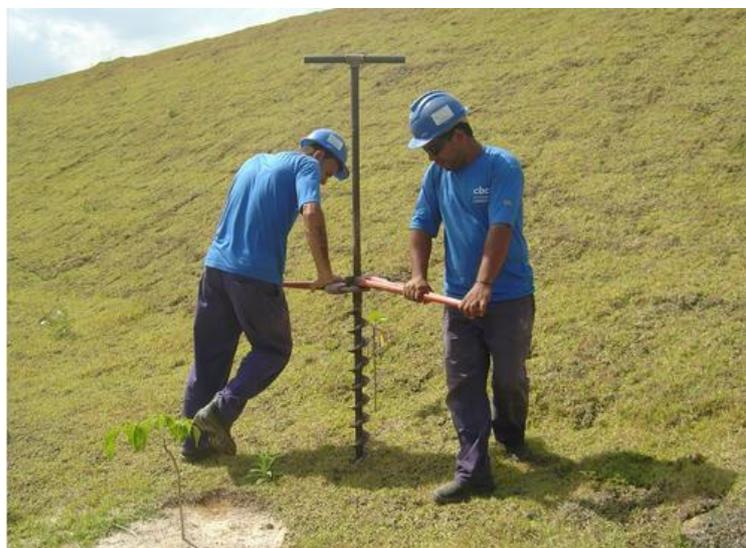
Figura 3.2 – Exemplo de sondagem a trado realizada em campo.
