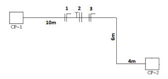
Circuito 1: 2 x 4 mm<sup>2</sup> Circuito 2: 3 x 6 mm<sup>2</sup> Circuito 3: 2 x 2,5 mm<sup>2</sup>
